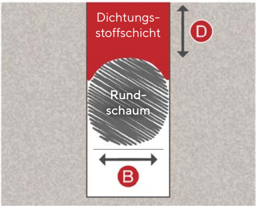
B= Fugenbreite D= Fugentiefe
